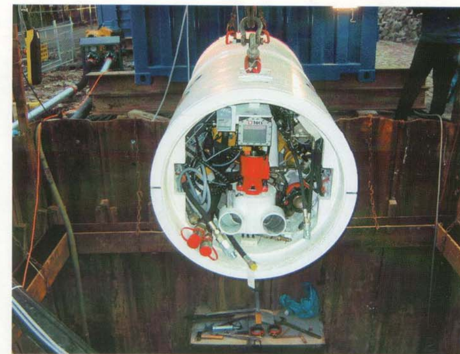
Blick in die in der Frickestraße verwendete Vortriebsmaschine mts 1000
